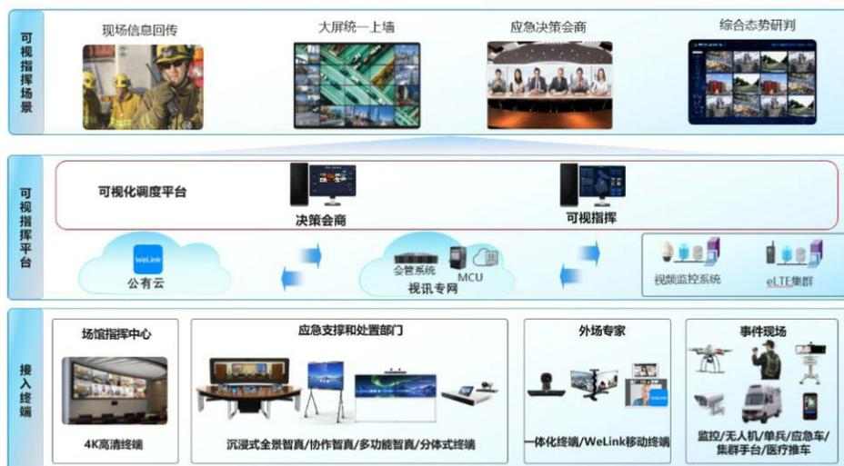
图 7-7 应急可视化指挥系统架构示意图
