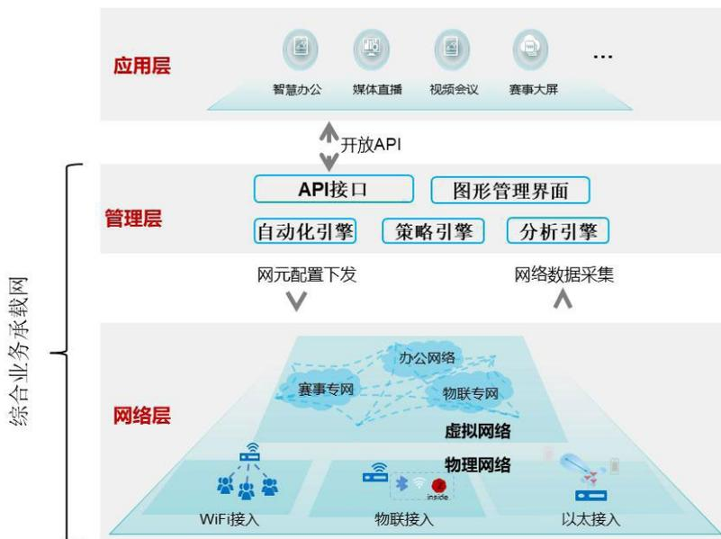
图 6-6 场馆综合承载网架构示意图
