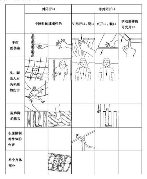
图 A. 1 可能致人伤害的结构形式示意图
